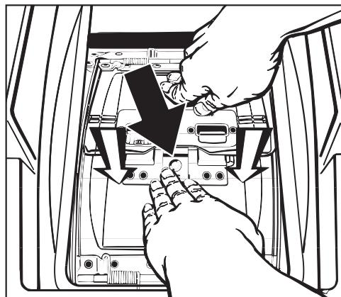
■ Pritisnite bravicu (**crna strelica**) i istovremeno pritisnite prema otraga prednju polovicu otvora dok se ne otključa (smjer strelice).
