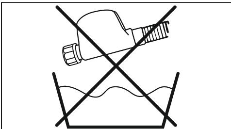
**Kućište crijeva za dovod vode ne uranjati u tekućinu!**
