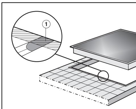
Fuge ① i crtkana područja ispod ruba za brtvljenje na ploči za kuhanje moraju biti glatki i izravnati tako da ploča za kuhanje dobro leži i da brta ispod ruba uređaja osigurava brtvljenje prema radnoj ploči.
