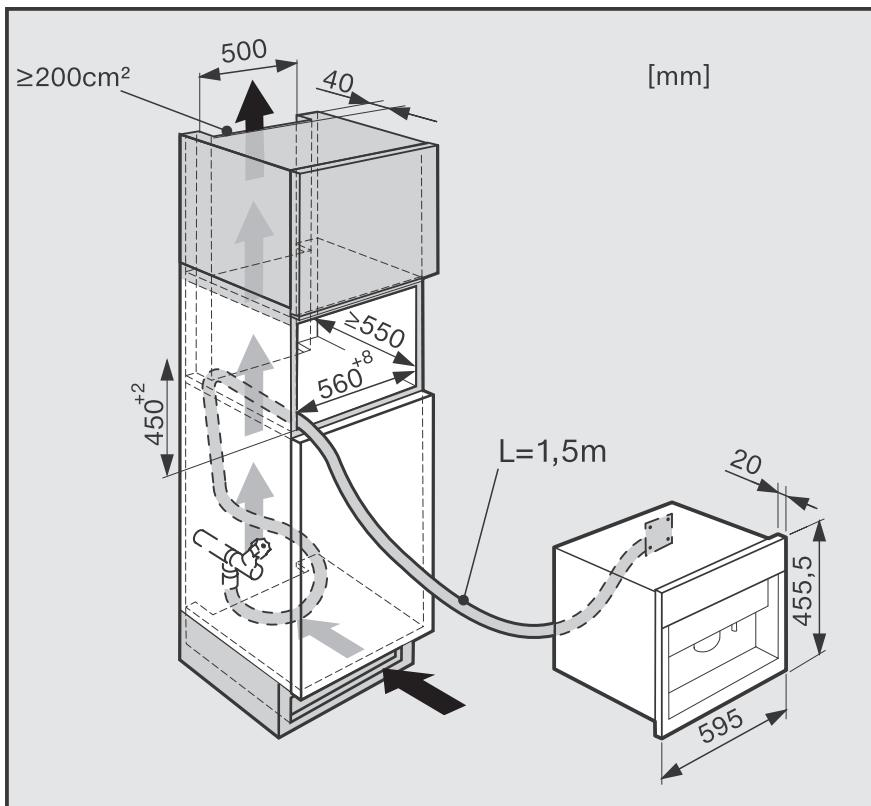
Moguća je kombinacija s drugim ugradbenim uređajima tvrtke Miele. Kod kombinirane ugradnje iznimno je važno da je aparat za kavu odozdo odijeljen zatvorenom međupodnicom (osim kod kombinacije s ugradbenim grijачem posuđa/jela).
