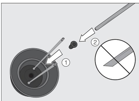
Obratite pažnju na to da zakošeni kraj cjevčice od nehrđajućeg čelika **nije** umetnut u brtvu. Brtva se može oštetiti.
