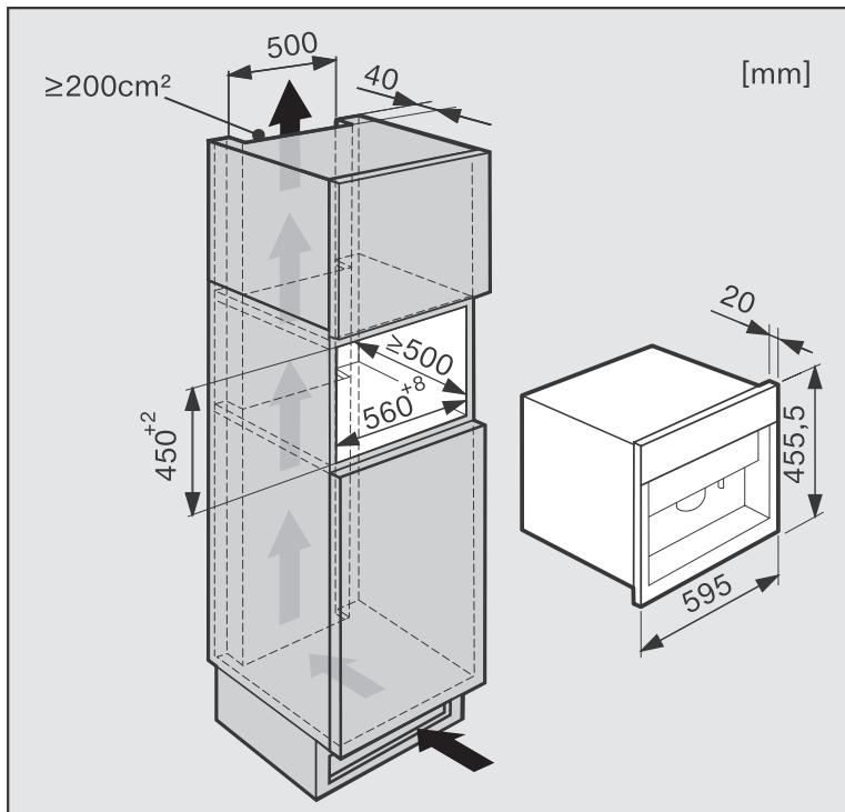
Moguća je kombinacija s drugim ugradbenim uređajima tvrtke Miele. Kod kombinirane ugradnje iznimno je važno da je aparat za kavu odozdo odijeljen zatvorenom međupodnicicom (osim kod kombinacije s ugradbenim grijачem posuđa/jela).
