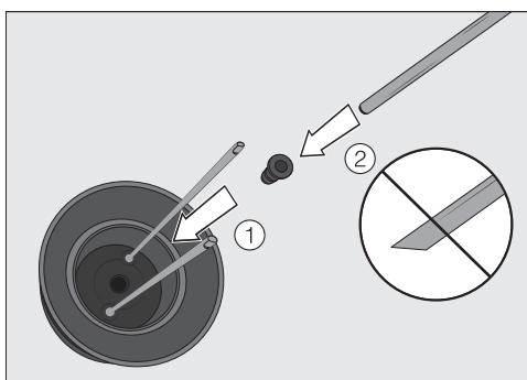
Obratite pažnju na to da zakošeni kraj cjevčice od nehrđajućeg čelika **nije** umetnut u brtvu. Brtva se može oštetiti.
