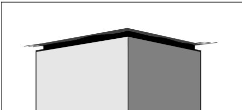
Između dimovoda i stropa može se montirati **okvir**. On se može primijeniti zbog vizualnog dojma kada između stropa i dimovoda postoji razmak (reška). To primjerice može biti potrebno kada strop nije vodoravan ili nije ravan. Kuhinjska napa postavlja se okomito pomoću priloženih traka za izjednačavanje. Vizualne nejednakosti između dimovoda i stropa pokrivaju se reškom.
