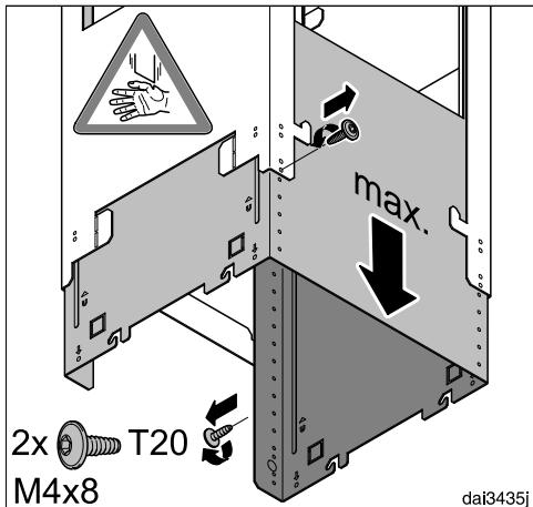
■ Odozdo čvrsto držite nosivi stalak, odvrnite dva vijka za pričvršćenje i nosivi stalak razvucite na maksimalnu dužinu.
