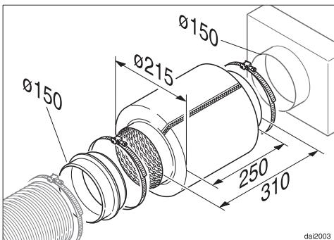
U odvodnu cijev može se umetnuti prigušivač buke (dodatni pribor) koji služi za dodatno prigušivanje šumova.
