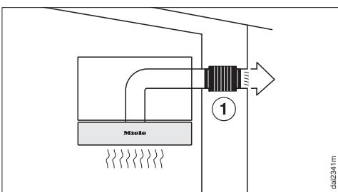
Prigušivač buke prigušuje šumove ventilatora prema van, ali i vanjske šumove koji kroz odvodnu cijev prodiru u kuhinju (npr. ulična buka). Zato se prigušivač buke pozicionira što je moguće bliže izlazu odlaznog zraka ①.
