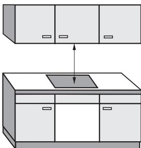
Između ploče za kuhanje i nape iznad mora se ostaviti razmak kojeg preporučuje proizvođač nape. Ako proizvođač nape ne navodi razmak ili se iznad uređaja nalaze lako zapaljivi materijali (npr. daska za vješanje), sigurnosni razmak mora iznositi najmanje 760 mm.
