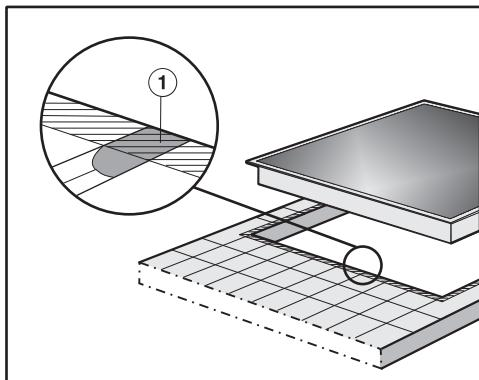
Fuge ① i crtkana područja ispod ruba za brtvljenje na ploči za kuhanje moraju biti glatki i izravnati tako da ploča za kuhanje dobro leži i da brtva ispod ruba uređaja osigurava brtvljenje prema radnoj ploči.
