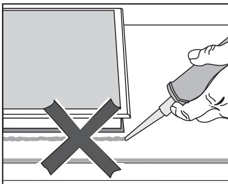
Ploča za kuhanje i radna ploča mogu se oštetiti ako će možda trebati vaditi ploču za kuhanje, a ploča za kuhanje brtvljena je masom za fugiranje. Između ploče za kuhanje i radne površine nemojte koristiti masu za fugiranje.
