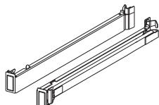
FlexiClip teleskopske vodilice mogu se pričvrstiti u svaku razinu umetanja i u potpunosti izvući iz prostora za pripremu jela.
