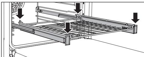
Nosivost FlexiClip teleskopskih vodilica iznosi 15 kg.
