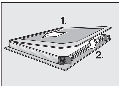
■ Okretajem zatvorite obje blokade za ploče na vratima prema unutra.
